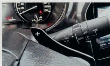
Kromě automatického režimu má řidič k dispozici možnost manuální sekvenční volby převodových stupňů
